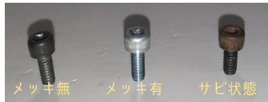
写真のようにメッキがない状態では徐々にサビてしまいます
